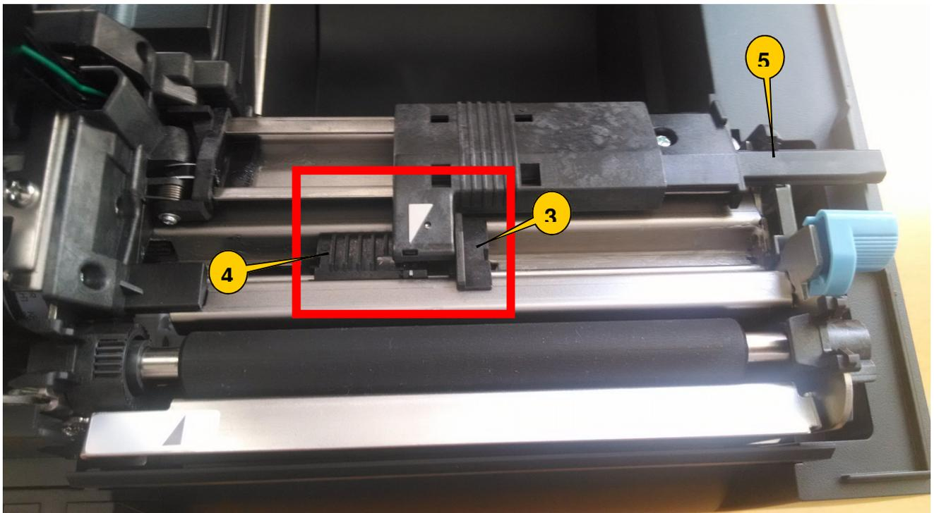
Öffnen Sie nun den Hebel (5) und führen Sie die Etiketten wieder in den Drucker ein. **Achten Sie darauf, dass die Etiketten unter dem Hebel (5) durchgeführt werden.**
